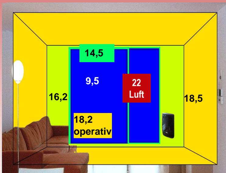
Kalte Bauteiloberflächen führen in schlecht gedämmten Häusern zu asymmetrischen Strahlungstemperaturen.
